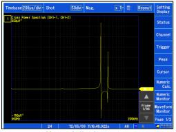
**Normal display** X axis:Log Y axis:Lin-Real
